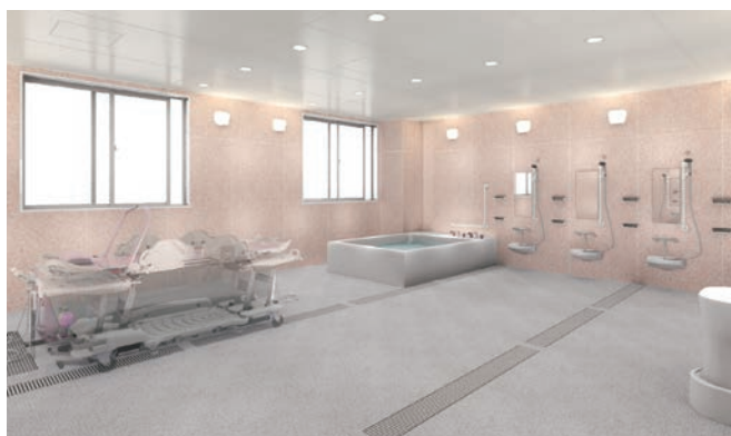
介護入浴機器（機械浴槽）+大型規格サイズ浴槽+汚物流し設置
