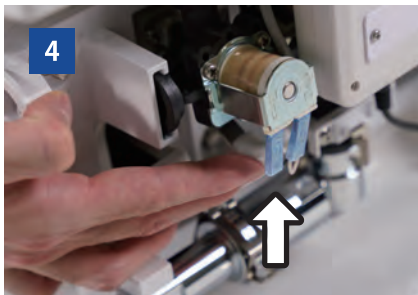
手動レバー(バルブ)を持ち上げバルブを開く。 開くと、水が出ます。
