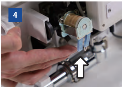
4 手動レバー(バルブ)を持ち上げバルブを開く。開くと、水が出ます。
